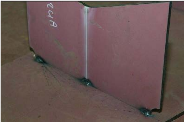
Figuur 3-13: Met een hecht blijven de metalen delen goed op hun plaats liggen.
